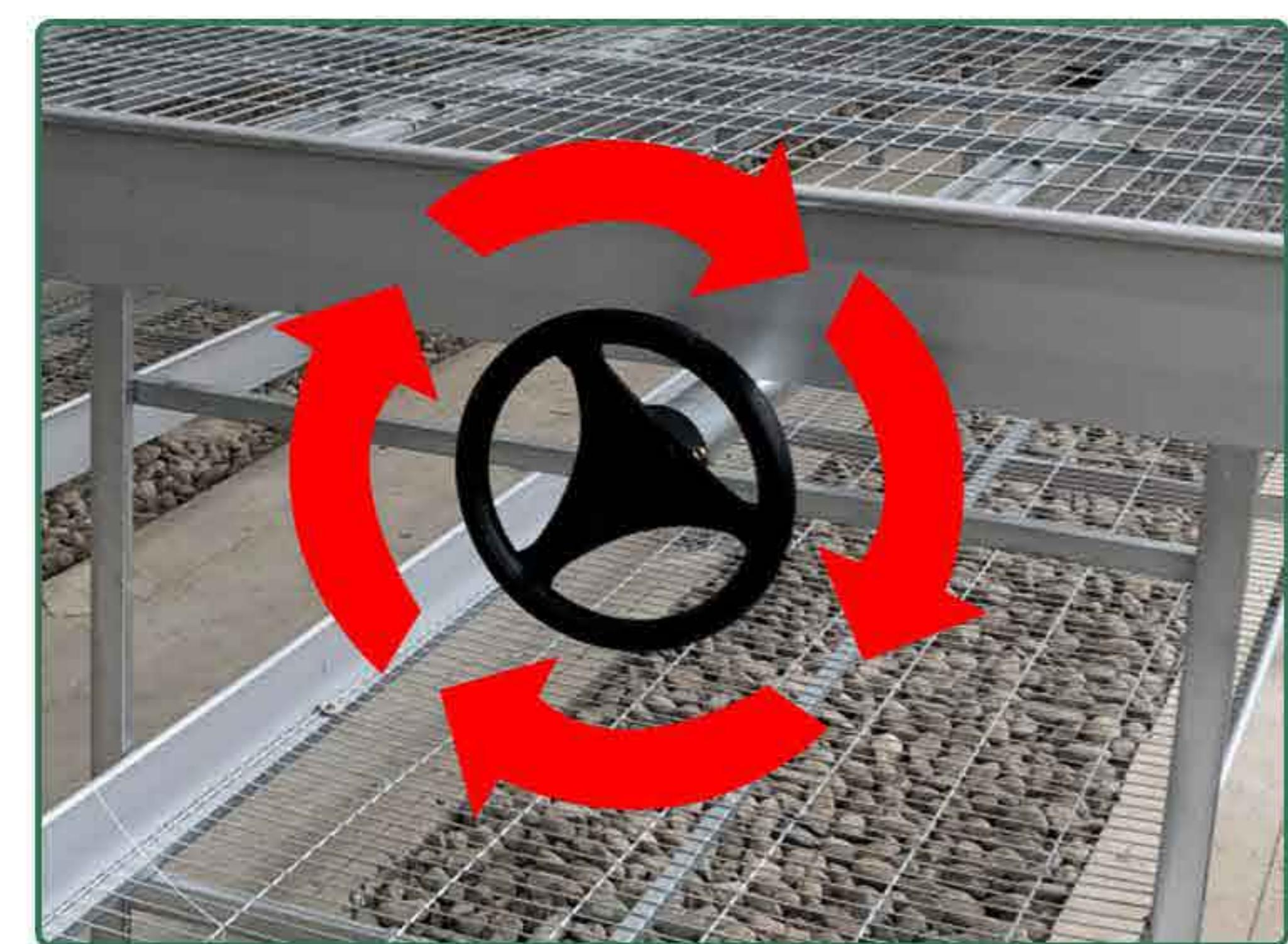
转动手轮，即可使苗床的板面进行平面移动
