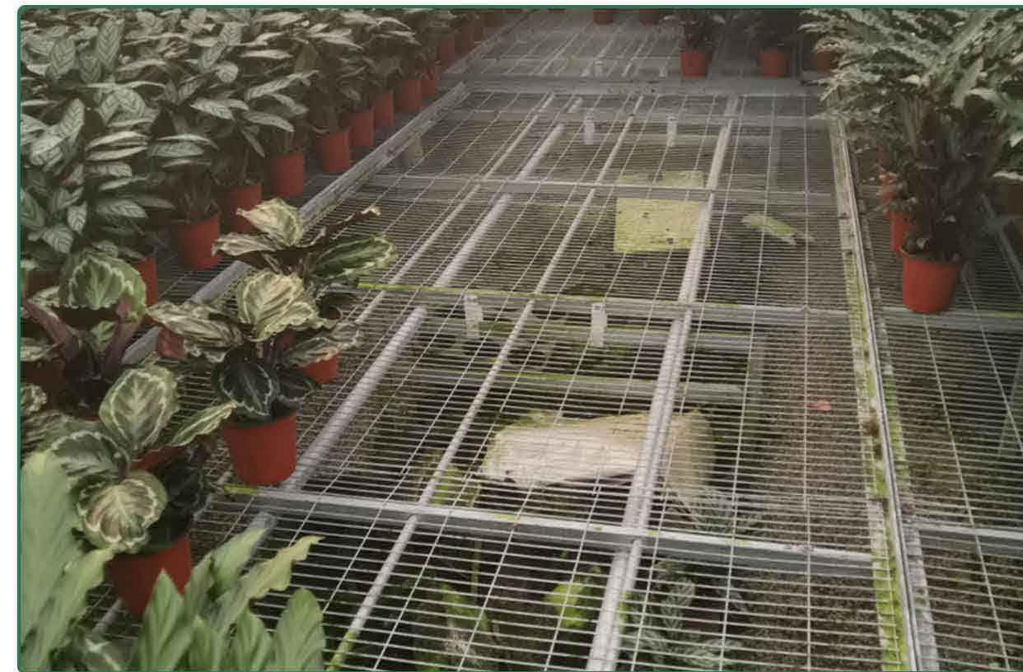
苗床支架采用热镀锌钢管，边框采用铝合金，苗床网表面采用镀层防腐处理；高度可进行微调，具有防翻限位装置，且可以在任意苗床之间产生0.8m的作业通道。
